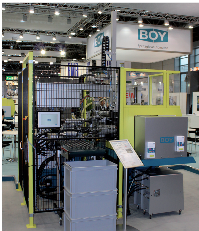
Das für die Maschinengrößen BOY 35 E bis BOY 100 E konzipierte Handling BOY LR 5 in Aktion. Zu sehen ist dies auf dem Youtube-Kanal: https://www.youtube.com/watch?v=QiWaGmA-h3M
